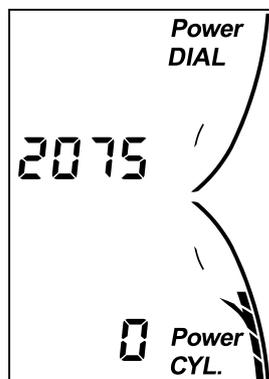
A posição da agulha defeituosa ou empenada é mostrada. Ao girar o cilindro da máquina, o aparelho de avaliação retrocede a contagem para zero.
